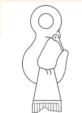
Afbeelding: Onjuiste verbinding van het product met een haak met een te kleine radius
